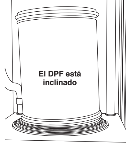
INCORRECTO Espacio entre el DPF y el adaptador inferior.
