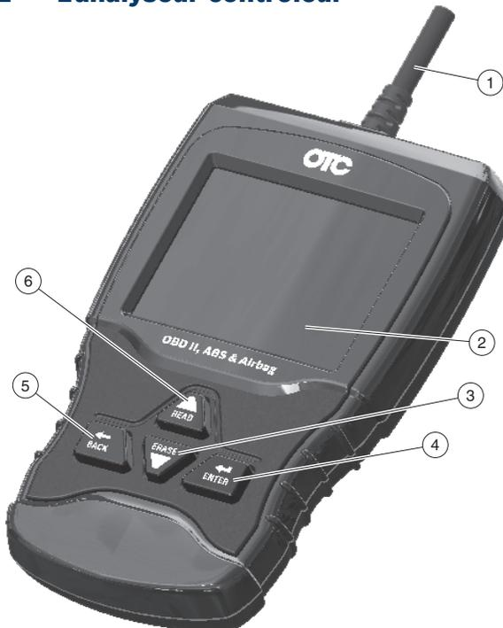
1. Le câble du DLC procure une connexion à l'interface du véhicule.
