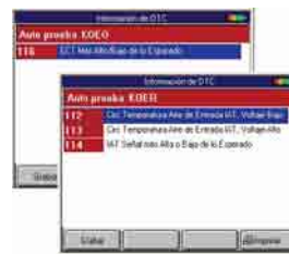
Figura 6.14: Información de DTC (KOEO y KOER)
